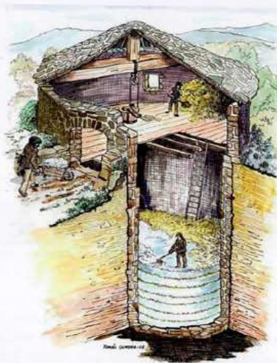
Figura 15. Esquema de funcionamento dun pozo de neve ou neveira
